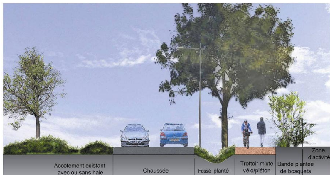
Principe du profil de la rue de la Borderie
