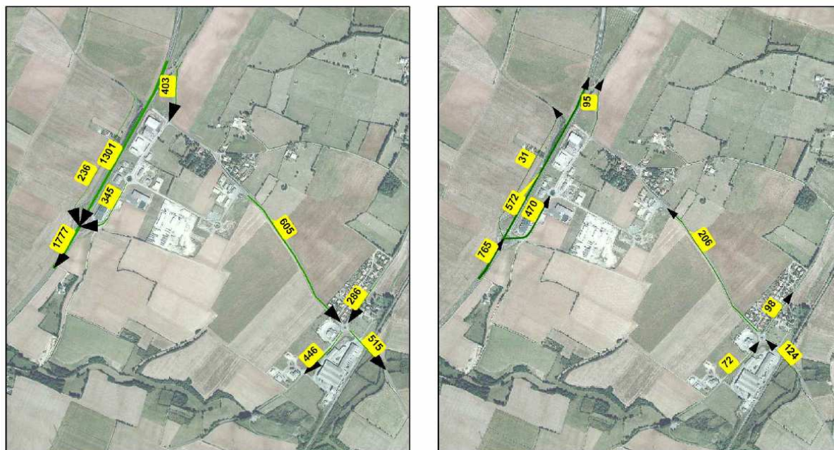
Nombre de véhicules moyens par jour entre 7 et 9h du lundi au vendredi. Vers le sud Vers le nord
