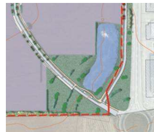
Dispositifs de rétention des eaux pluviales projetés
