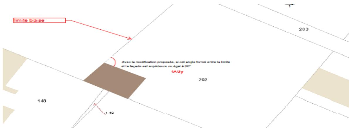
Lorsque le bâtiment à construire ne jouxte pas une limite séparative, la distance L doit être au moins égale à H/2 sans pouvoir être inférieure à 3 mètres (Fig. F).
