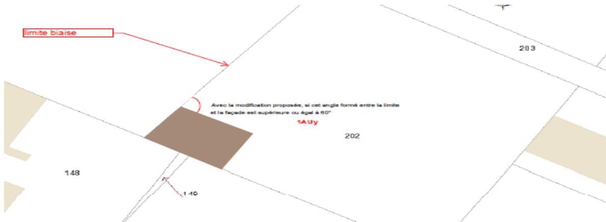
Lorsque le bâtiment à construire ne jouxte pas une limite séparative, la distance L doit être au moins égale à H/2 sans pouvoir être inférieure à 3 mètres (Fig. O).
